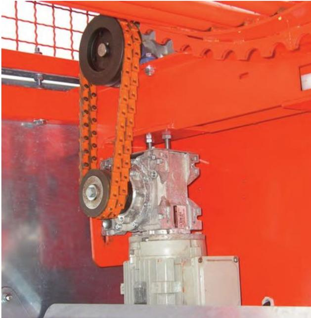
Durchzugstarker Antrieb mit 1,1 KW 16A Elektromotor. Steckdose mit Phasenwender
