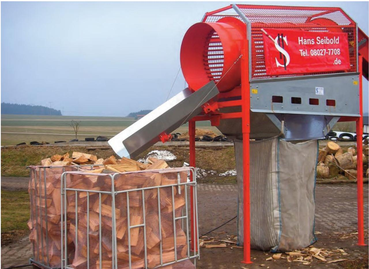
Hochleistungstrommelreiniger für Splitterfreies Ofenholz.
